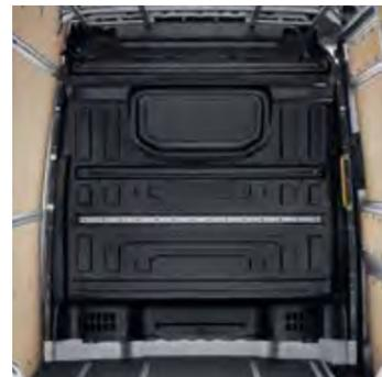
**01 Pared divisoria sin ventanilla.** La pared divisoria conforme a la norma DIN 75410-3 está completamente cerrada. Puede solicitarse de forma opcional un compartimento portacargas en el techo sobre la cabina del conductor para la versión con techo alto, de serie en el techo sobreelevado. |FU|
