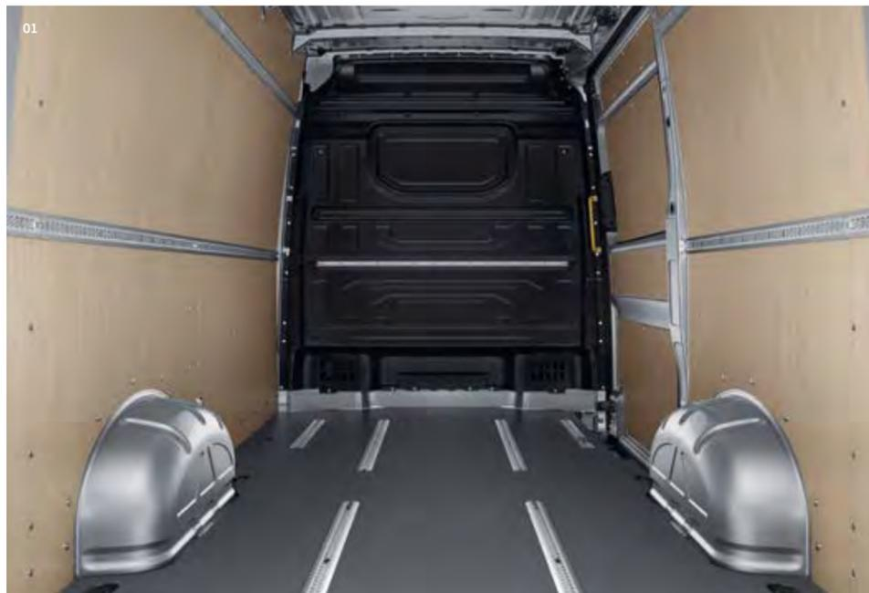
**01 Suelo de madera.**<sup>1) 2)</sup> El robusto suelo de madera de 8 mm en el compartimento de carga conforma la superficie óptima para su carga. La robusta madera de haya garantiza una estabilidad y durabilidad excelentes. |FU|
