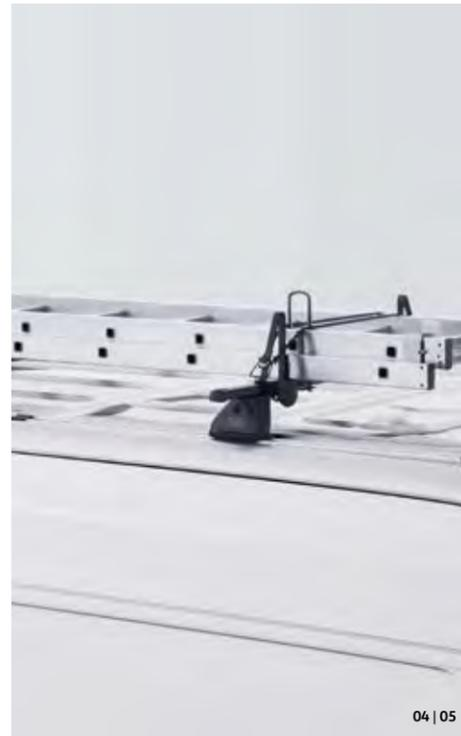
**04 Portaescaleras.** Permite transportar escaleras en el techo de forma cómoda y segura. Este portaescaleras ajustable es fácil de utilizar y de montar sobre el soporte básico o sobre un portaequipajes. |FU|
