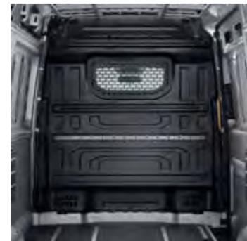
**02 Pared divisoria con ventanilla y rejilla protectora.\*** La inclinación única del cristal evita reflejos en el campo de visión del conductor. La rejilla proporciona, además, una protección adicional a la ventanilla, al conductor y a los pasajeros, por ejemplo en caso de frenada brusca. Para la ventanilla hay dos variantes disponibles: ventanilla cerrada en la pared divisoria o ventanilla deslizante flexible. |FU|
