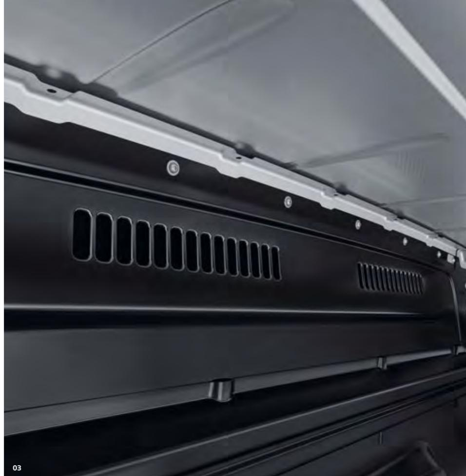
**03 Sistema climatizador "Climatic" con control electrónico y un segundo evaporador.** Para el transporte profesional de pasajeros o de mercancías sensibles a la temperatura, el Crafter también se puede equipar con un compartimento de pasajeros/de carga climatizado. El segundo evaporador se integra en el techo de la cabina del conductor y los orificios de ventilación se encuentran por encima de la partición. |FU|
