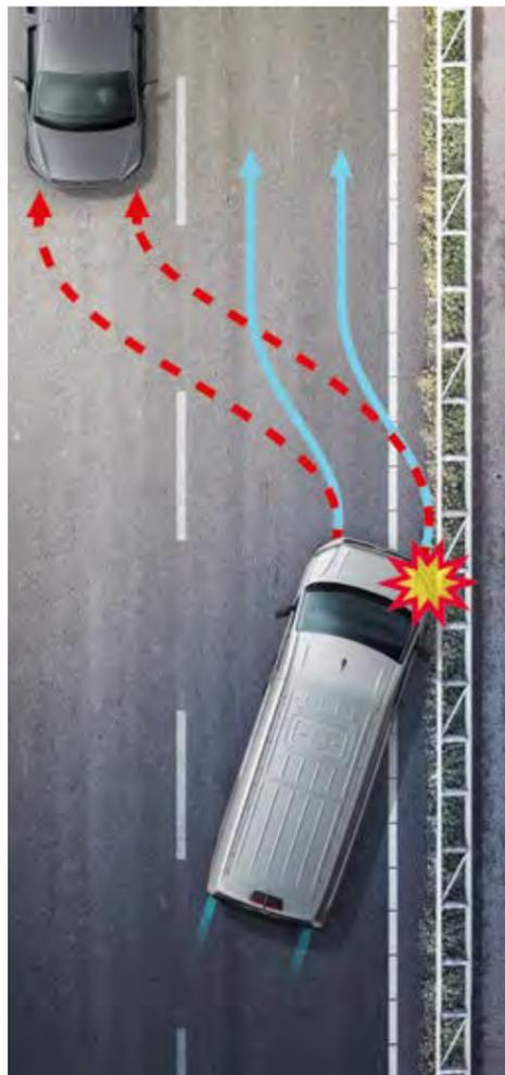
**(MCB) Freno multicolisión.\*** Inicia la frenada tras una colisión para evitar colisiones en cadena o reducir su gravedad. El sistema automático de frenado poscolisión se activa cuando dos sensores independientes detectan un accidente. Tras un breve periodo, el vehículo empieza a frenar progresivamente hasta 10 km/h y el conductor puede retomar el control en cualquier momento. | FU | CH |
