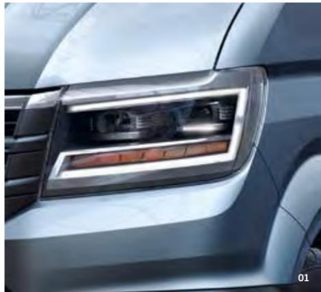
**01 Faros delanteros LED.** La luz diurna, de cruce y de carretera, utilizan luces LED de ahorro energético. La alta fiabilidad y la larga vida útil de los LED aumentan la seguridad y disminuyen la probabilidad de fallos. |FU|CH|
