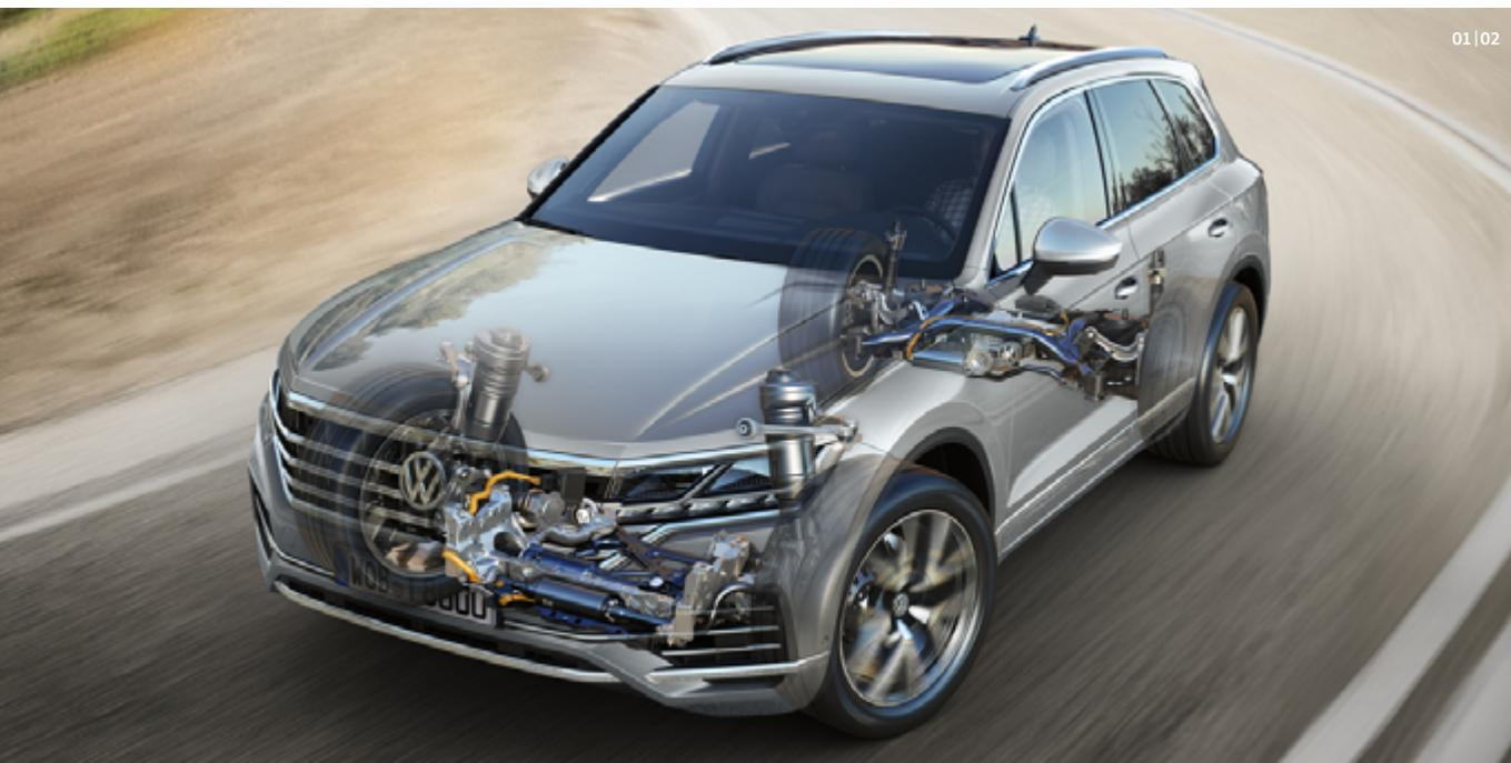
**01** La suspensión neumática con regulación de altura y regulación electrónica de la amortiguación te permitirá adaptar la configuración del Touareg a cualquier terreno. Podrás modificar la altura del vehículo en hasta 95mm, así como la dureza de los amortiguadores, para disfrutar en todo momento de la conducción del Touareg. **R**
