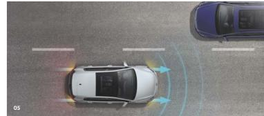
05 Puede salvar vidas en caso de emergencia: el sistema de asistencia "Emergency Assist" detecta la indisposición del conductor y toma el control del vehículo.1) Cuando el sistema no detecta ninguna acción sobre el volante, los frenos o el acelerador, toma el control del vehículo manteniéndolo en el carril y reduciendo la velocidad hasta detenerlo. "Emergency Assist" está disponible exclusivamente como parte del paquete de asistencia al conductor.
