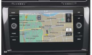
02 El sistema de navegación "Discover Media" para el sistema de radio "Composition Media" incorpora una pantalla TFT a color de 20,3 cm (8 pulgadas), con mapas de Europa, pantalla táctil con sensor de proximidad y reproductor de CD que puede reproducir formatos MP3, AAC y WMA con ocho altavoces. Además, el sistema incluye dos ranuras para tarjetas SD, una entrada AUX-IN, una entrada USB y conexión telefónica por Bluetooth. En la pantalla puedes ver, entre otros, la temperatura exterior.
