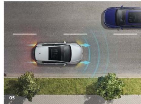
**01** Cuida de ti – y de los demás: El **sistema de observación del entorno “Front Assist” incluye la función de asistente de frenada en ciudad con reconocimiento de peatones** que en caso de colisión inminente puede ayudar a reducir la gravedad del accidente o, incluso, a evitarlo. Reconoce a los peatones y otros obstáculos en el camino y advierte al conductor.<sup>1)</sup> Si no hay respuesta, el vehículo inicia una maniobra de frenado de emergencia. **S**
