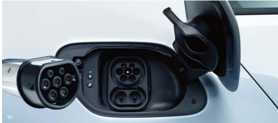
**01|02** Gracias al **sistema de recarga combinada (CCS)** el nuevo e-Golf tan solo necesita una sola toma para realizar la recarga con dos enchufes distintos: el de corriente alterna con cable de recarga para tomas de red, estaciones de recarga y Wallbox – y el de recarga rápida con corriente continua para estaciones de recarga públicas CCS. [O](#)
